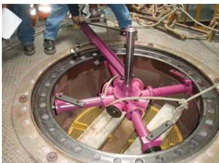
Centrado del dispositivo de medición
